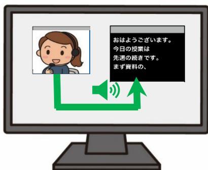
パソコンで再生される音声を、同じパソコン内で起動している音声認識ツールに認識させる。外付けスピーカーなどで音を聞くことはできない。
