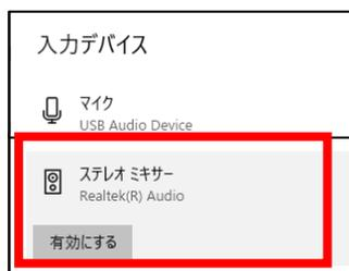
④サウンドの設定画面に戻り「入力デバイス」から「ステレオミキサー」を選択します。
