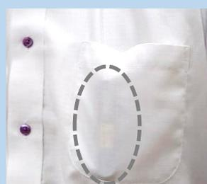
マイクが配置されているディスプレイ面が内側になっていたり、完全に隠れていると、声の集音ができなくなるとともに、布擦れの音がノイズとして入るため聞き取りが困難になる
